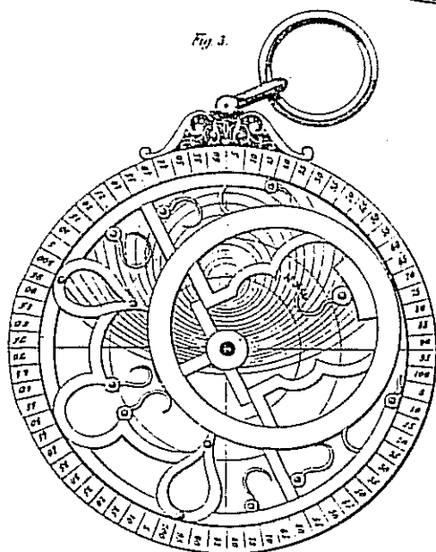
Fig. 1 Araignée. Fig. 2. Astrolabe vu par le dos placé pour observer un astre dont la hauteur est de 42 degrés Fig. 3. Astrolabe monté et vu de face, on a supprimé une grande partie de l'araignée.
